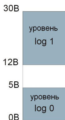
Рис. 2) Логические уровни входного сигнала
